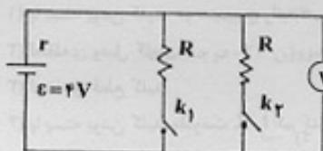
در شکل مقابل، هنگامی که یکی از کلیدها باز و دیگری بسته است، ولتسنج ۳ ولت را نشان می‌دهد. اگر هر دو کلید بسته شود، ولتسنج چند ولت را نشان خواهد داد؟
