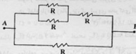
در شکل مقابل، اگر مقاومت الکتریکی بین دو نقطه‌ی A و B برابر  $2\Omega$  باشد، R چند اهم است؟
